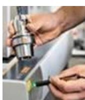
**Bildunterschrift:** Die Messdaten werden vom Voreinstellgerät an Hoffmann Group Tool Management gesendet und zentral gespeichert.
